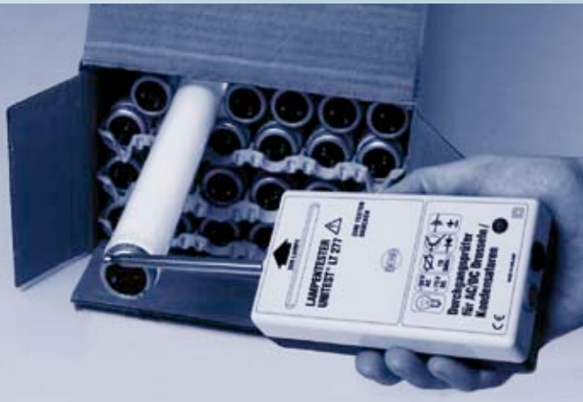
Qualitätsmanagement: Einzellampen werden geluxt
